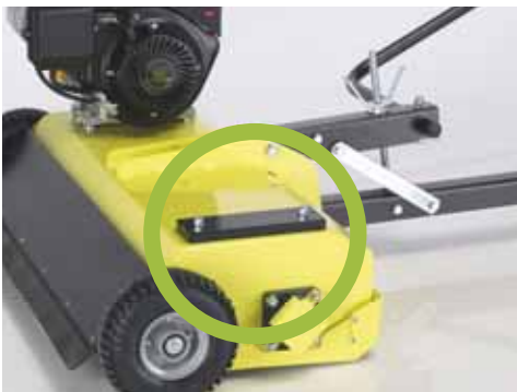
Zavorra di bilanciamento : per bilanciare il peso del motore posto su un lato della macchina, sul lato opposto è presente una zavorra (diversa a seconda del tipo di motore scelto)
