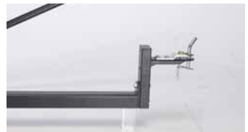
Attacco del timone registrabile per facilitare accoppiamento con qualsiasi tipo di trattorino o quad
