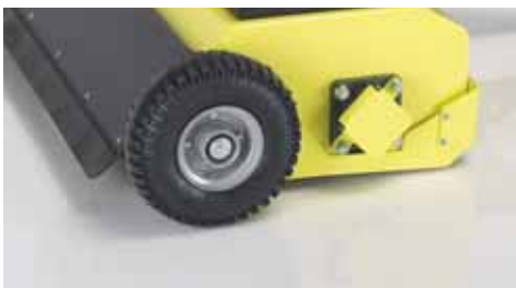
Ruote in gomma morbida che non danneggia l'erba, e semipiene che non si sgonfiano né si forano. Hanno cuscinetti a sfera, e sono montate su un asse di 20 mm di diametro
