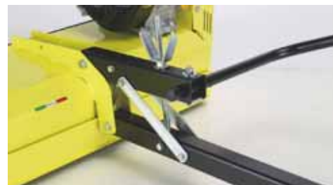
Sistema di regolazione altezza di lavoro. Da seduti sul trattorino/quad, tramite l'azionamento della leva si può sollevare la macchina affinché i coltelli non tocchino il terreno
